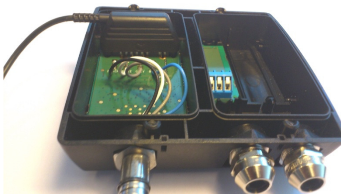
Рис. 35. Расположение 4-полюсного контакта в ULTRAFLOW® Ду 150-250.
