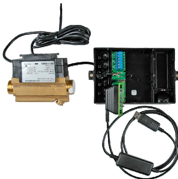
Рис. 42. Расположение 4-контактного разъема с адаптером для ULTRAFLOW® 14 в ULTRAFLOW® 14/24 (MULTICAL® 61/62).
