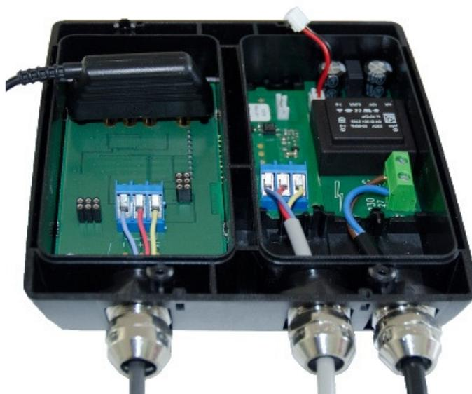
Рис. 46. Расположение 4-контактного разъема в делителе импульсов 66-99-907.
