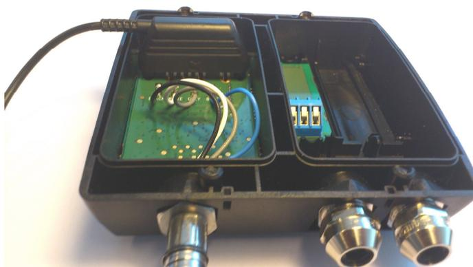
Рис. 44. Расположение 4-контактного разъема в ULTRAFLOW® 54 Ду150-250.
