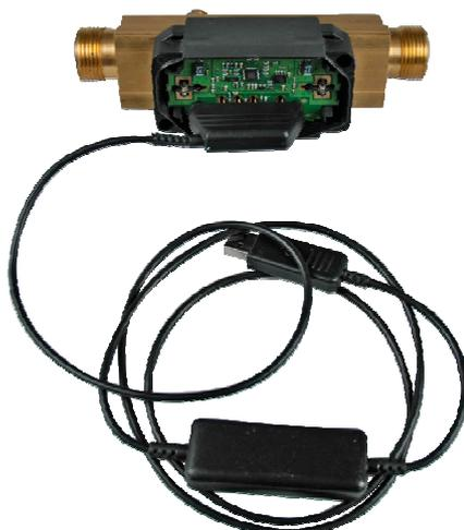
Рис. 41. Расположение 4-контактного разъема в ULTRAFLOW® 54.
