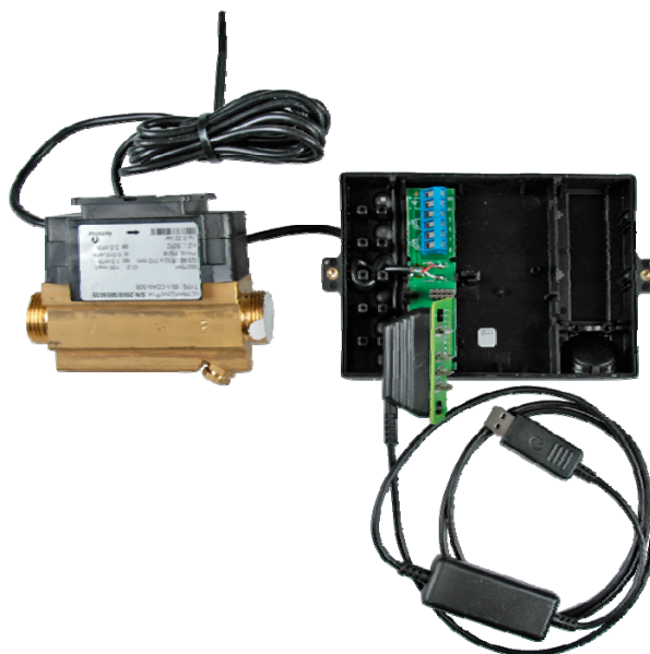
Рис. 52. Расположение 4-контактного разъема с адаптером для ULTRAFLOW® 14 в ULTRAFLOW® 14/24 (MULTICAL® 61/62).
