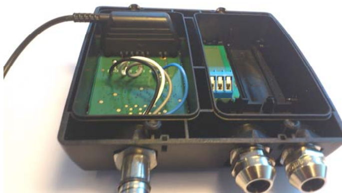
Рис. 54. Расположение 4-контактного разъема в ULTRAFLOW® 54 Ду150-250.
