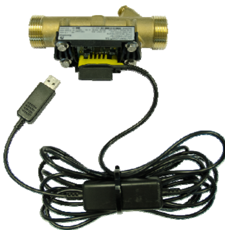
Рис. 51. Расположение 4-контактного разъема в ULTRAFLOW® 54 (H).
