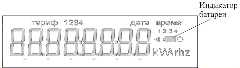
**Рисунок 1 – Экран счетчика**
