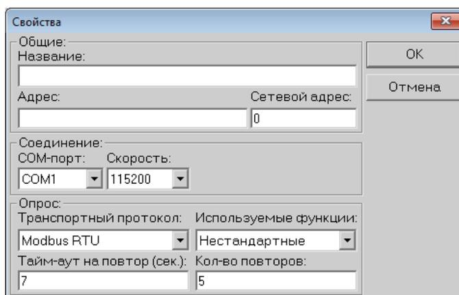
Сетевой адрес при работе с одним прибором устанавливать равным нулю.
