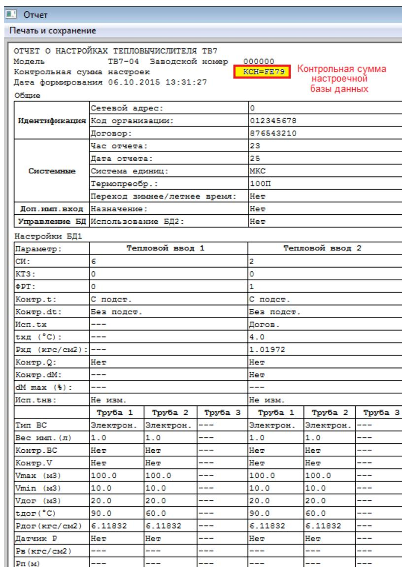
**Примечание** Контрольная сумма настроечной базы данных, отображаемая в программе будет точно такой же, если впоследствии загрузить конфигурационный файл в вычислитель.
